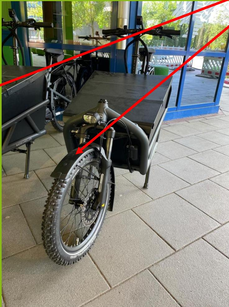
Damit die ausleihende Person sicher von A nach B fahren kann, müssen vor Fahrtantritt die Vorder- sowie die Hinterradschützer überprüft werden.
