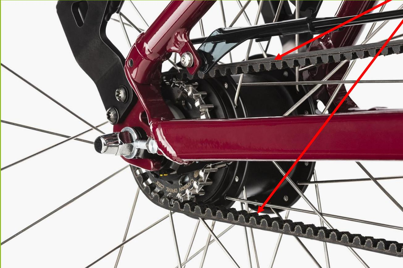
Damit die ausleihende Person sicher von A nach B fahren kann, muss vor Fahrtantritt der Antriebszahnriemen überprüft werden.
