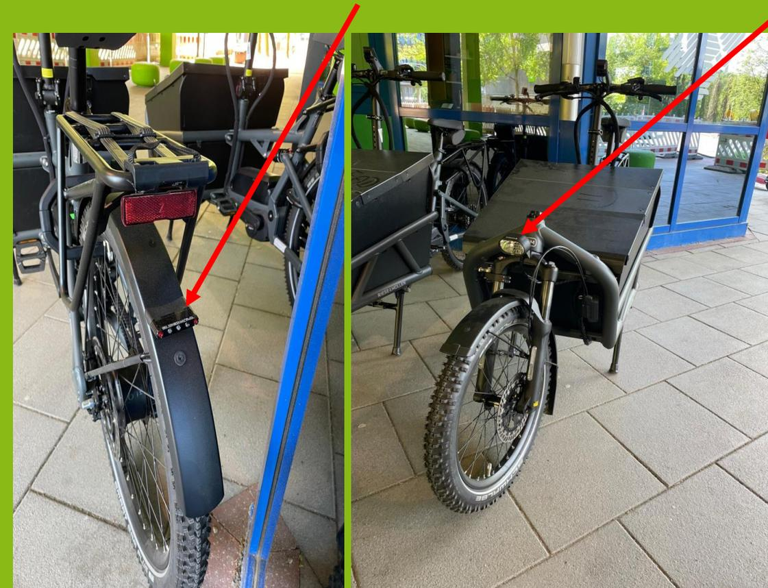
Damit die ausleihende Person sicher von A nach B fahren kann, müssen vor Fahrtantritt die lichttechnischen Einrichtungen überprüft werden.
