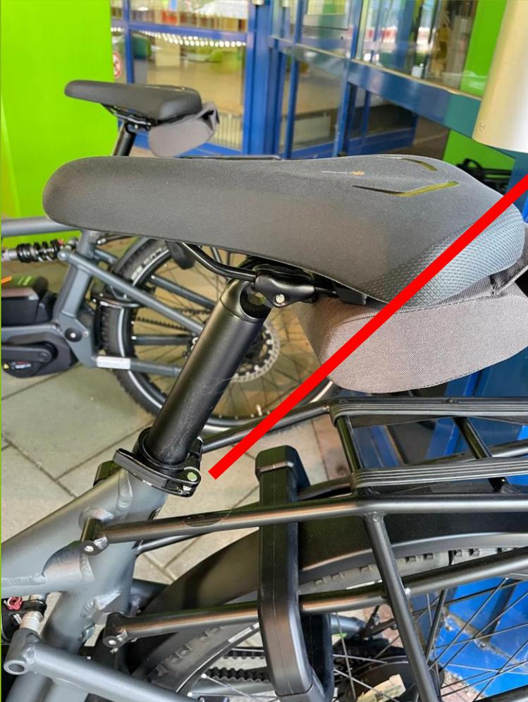
Durch Lösen des Schnellspanners kann die Sattelstütze bewegt werden.
