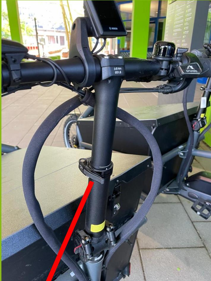
Bild 1: Lenkerschnellspanner
