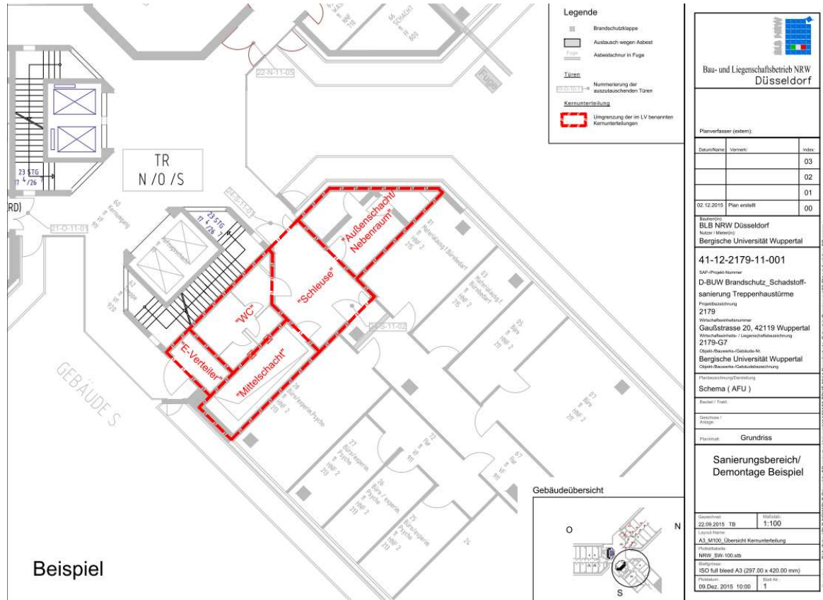
Bild 2.2: Anordnung der Raumeinheiten auf einer „Regelebene“ (Beispiel)
