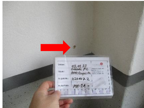
Foto 5.7: asbesthaltiger Putz; hier: auf Massivwand, Gebäude FC, 2. OG, Flur, Räume 2.82, 2.83, 2.84, Quelle: BUW1, Seite 33
